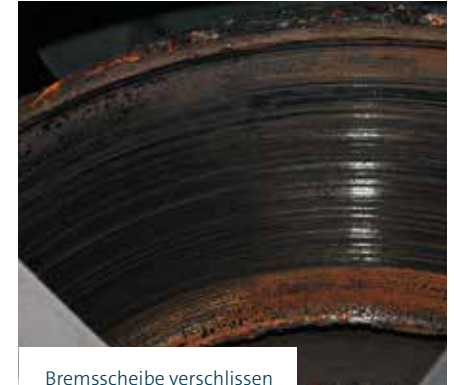
Brems Scheibe verschlissen
